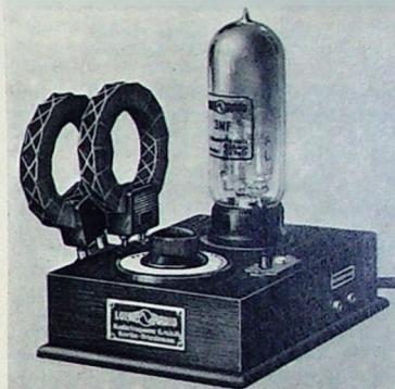
Aufbau der Loewe-Dreifachröhre
